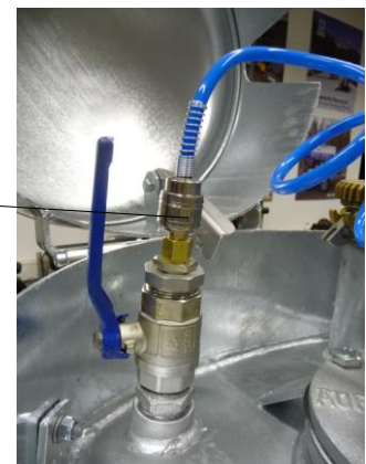
Druckregler extern, Entlüftungs- anschluss Innen- gewinde
