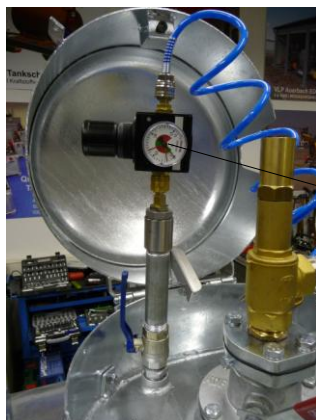
Druckregler auf Entlüftung direkt aufgesetzt, Anschluss Außen- gewinde
